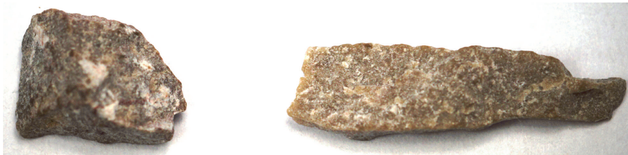
Rys. 3. Przykład ziarna foremnego (po lewej) i nieforemnego (po prawej) wapienia dewońskiego, rozdrabnianego w kruszarce A.
